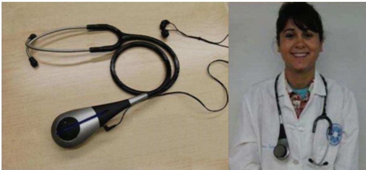
Figure 7 : Prototypes de stéthoscope électronique développés dans le cadre de projets collaboratifs incluant Alcatel-Lucent par la Société US Battelle.
